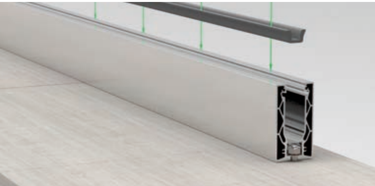
2. Unteres Verglasungsprofil einsetzen (im Außenbereich an den Entwässerungsbohrungen aussparen) insert lower glazing profile (for outdoor usage, blank out at the drain holes)
