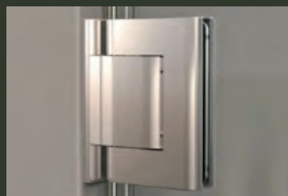
biloba 8010 jc pendeltürbänder Glas-Wand mit beidseitiger Platte Selbstschließendes Hydraulikband mit Dämpfung und Regelung der Schließgeschwindigkeit. Für Pendeltüren ohne oder mit Anschlag. Feststellung bei 90° Grundkörper komplett verkleidet mit zusätzlichen Abdeckungen aus Edelstahl V4 A Mit integrierter Nulllagenregulierung
