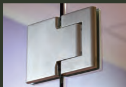
biloba 8015 jc pendeltürbänder Glas-Glas 180° Selbstschließendes Hydraulikband mit Dämpfung und Regelung der Schließgeschwindigkeit. Für Pendeltüren ohne oder mit Anschlag. Feststellung bei 90° Grundkörper komplett verkleidet mit zusätzlichen Abdeckungen aus Edelstahl V4 A Mit integrierter Nulllagenregulierung
